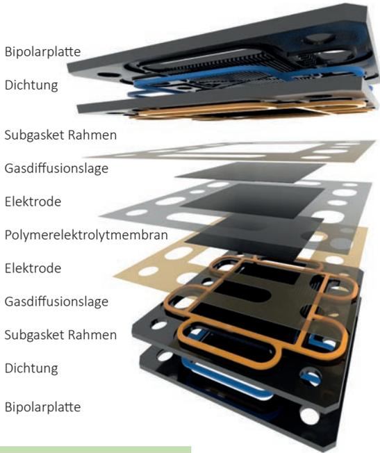
**i** Die Baugruppe aus Membran, Elektroden, Gasdiffusionslagen und Subgasket Rahmen wird Membran-Elektroden-Einheit genannt (Englisch „MEA“).
